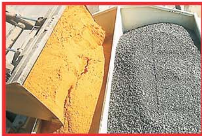
Cargar la tolva de arena
